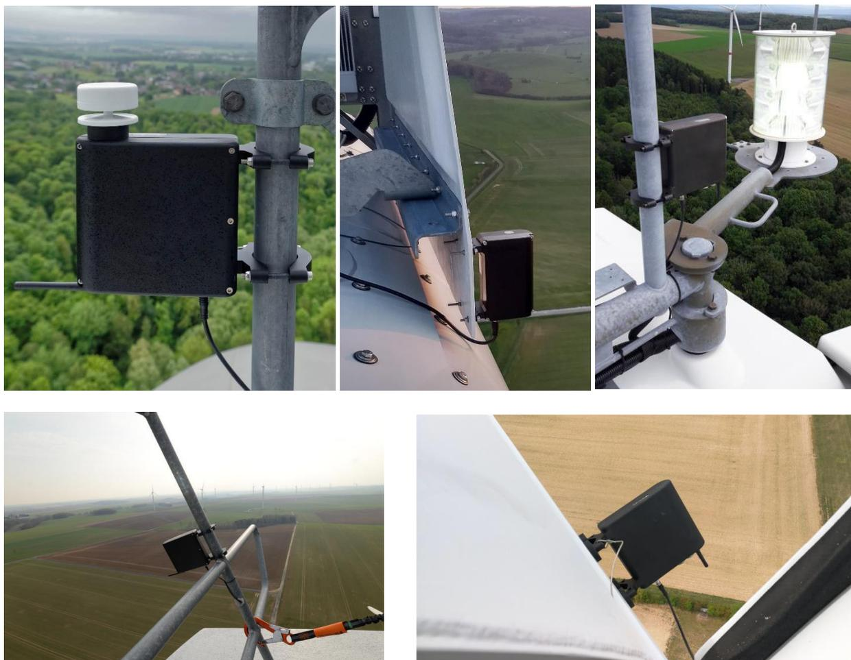
Figure 3: Implantation de l'enregistreur TrackBat (de gauche à droite, de haut en bas : Enercon, Nordex, Vestas, Senvion, Siemens)
